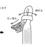
⑤引き出した部分が 輪になるようにして、 先端を引っ張り かたく結びます。
